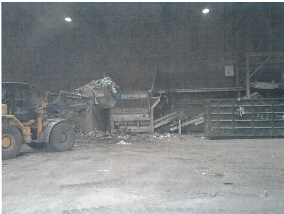
Obrázek 1 Příklad postupu přesunu SKO do pomaluběžného drtiče nakladačem
