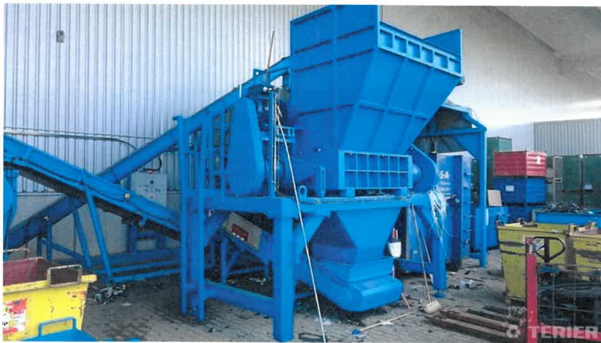
Obrázek 2 Pomaluběžný drtič – příklad provedení drtiče s násypkou (firma TERIER s.r.o.)
